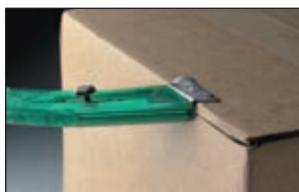
Rezanje pokrova kartona, s pomočjo varnostnega pokrova rezila, ki nam pokaže vogal in globino reza.
